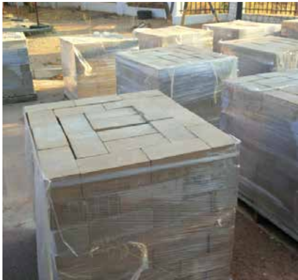
Robuste Backsteine aus Wüstensand und Flugasche von Kohlekraftwerken.
